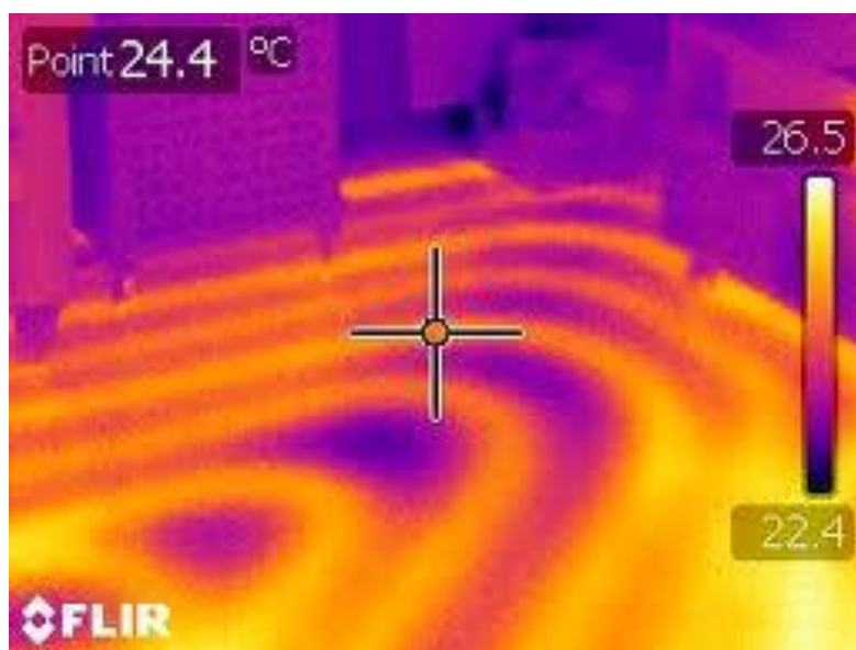
Figure IV.8 : Méthode de recherche par caméra infrarouge
