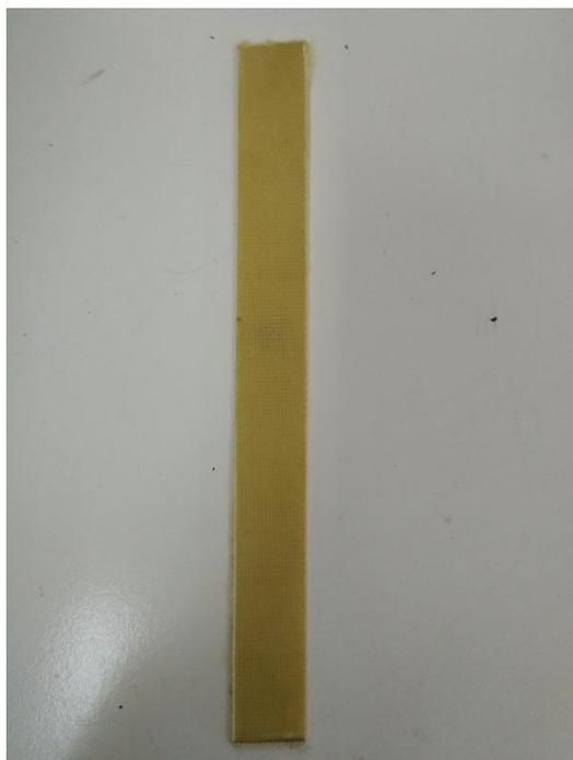
Figure III.23 L'éprouvette en aramide
