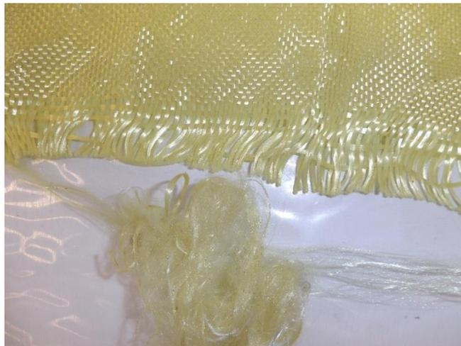
**Figure II.1** La fibre d'aramide
