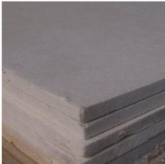
**Figure I.12** Fibre céramique
