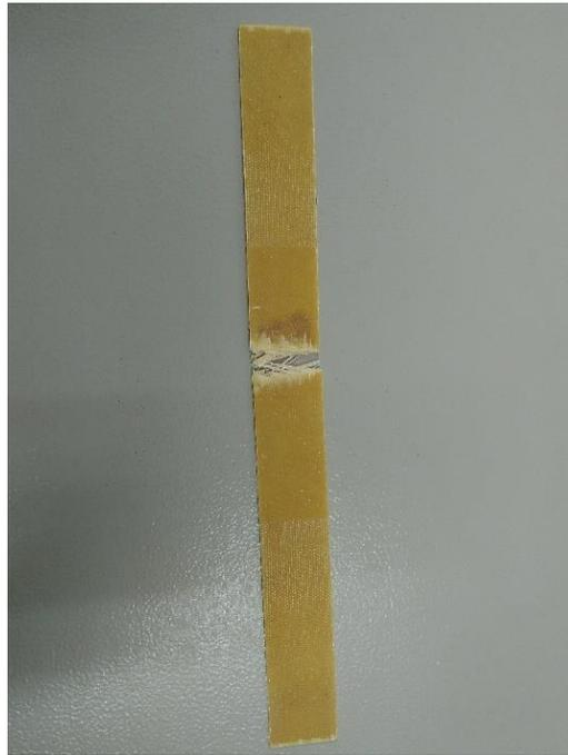
Figure III.7 L'éprouvette en fibre de kevlar
