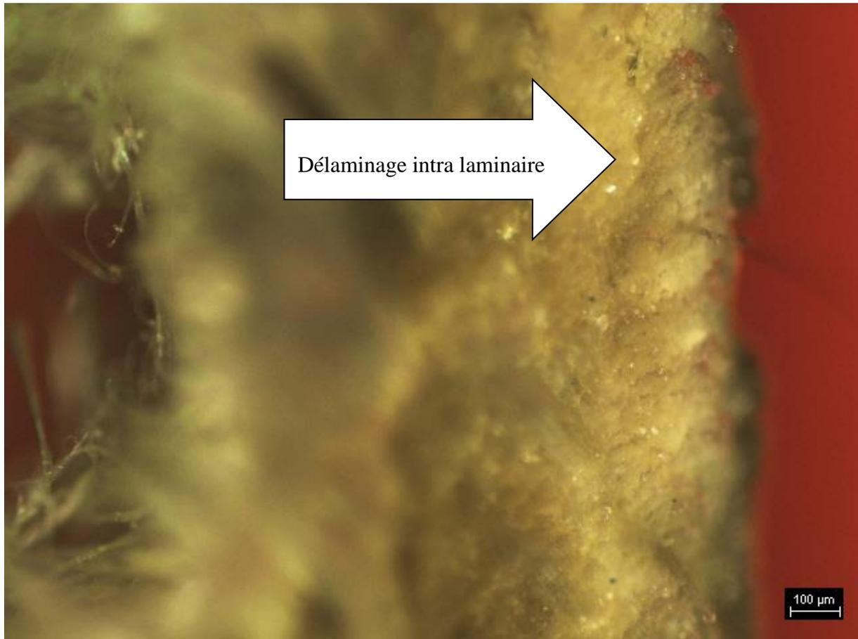
**Figure III.27** Microscopie optique, coupe transversale, (délaminage)
