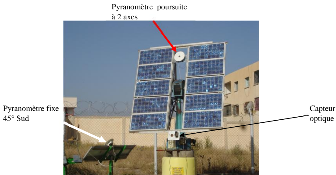
Fig. III.1: Système de poursuite Auresolar sur site avec positions du capteur optique et emplacement des pyranomètres.
