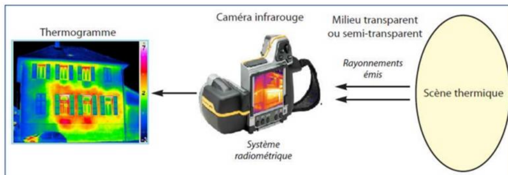
Fig IV.2 : Principe de fonctionnement de la caméra infrarouge [BRA].
