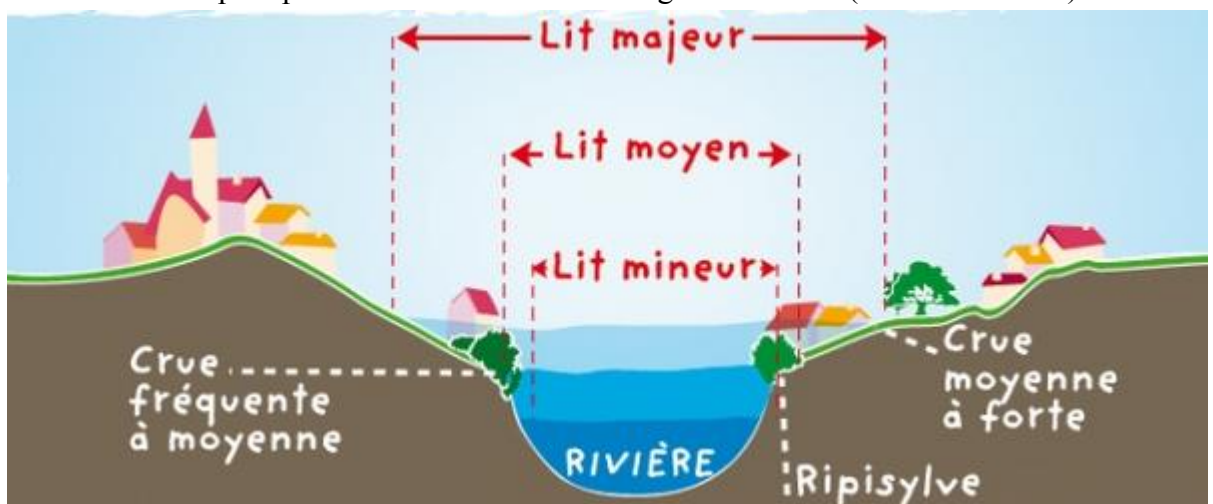
Figure I.3. Débordement direct d'un cours d'eau dans son lit majeur à cause d'une forte crue
