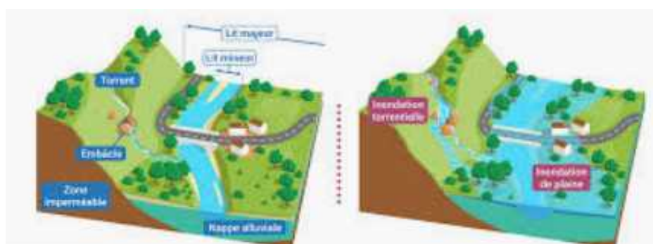
Figure I. 4 : inondations par crues torrentielles
