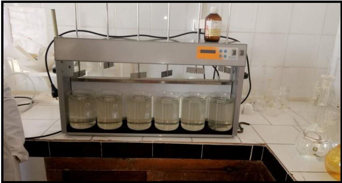
Figure n°12 : Essai du Jar-test station « Chaiba »
