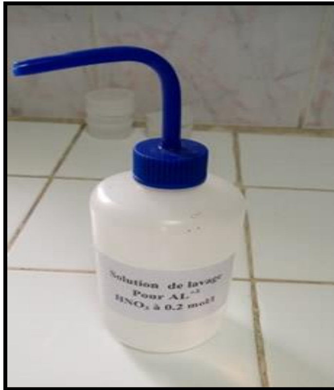
Figure n°38 : solution de lavage d'aluminium.
