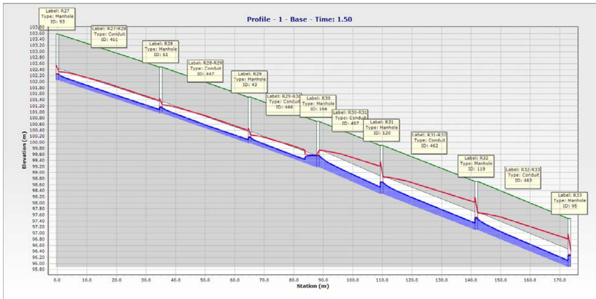
Fig. IV.24 : Profil en long du collecteur R27 à R33 simulé par le modèle de la pluie de double triangle pour la période de retour de 50 ans.
