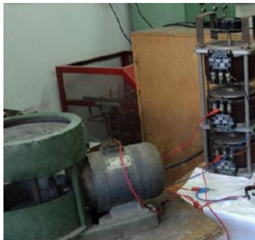
Figure 31 : Moteur asynchrone triphasé (270W) utilisé en essais expérimentaux avec autotransformateur [3]
