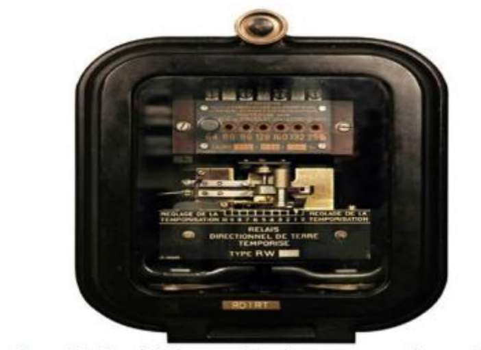
Figure IV : 5 relais électromécaniques marquent cdc type Rvw1-1940
