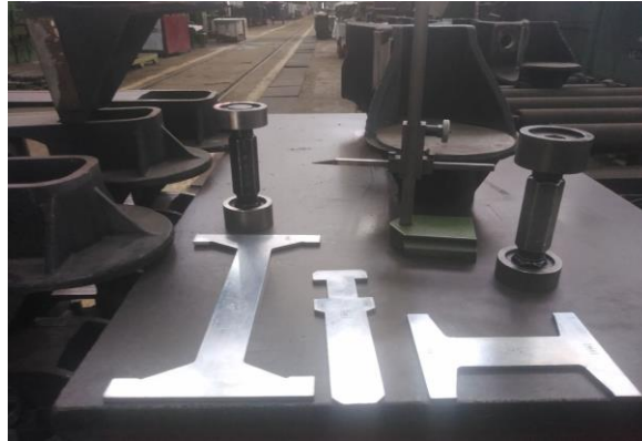
Figure 30 : Instruments de mesure et de contrôle des appuis.
