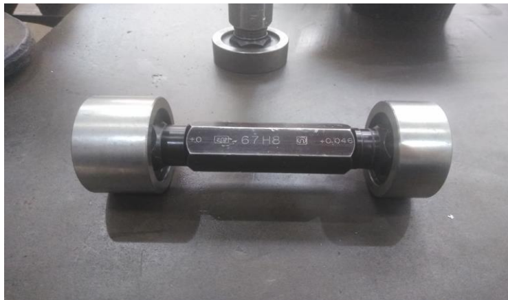
Figure 32 : Tampon double lisse.
