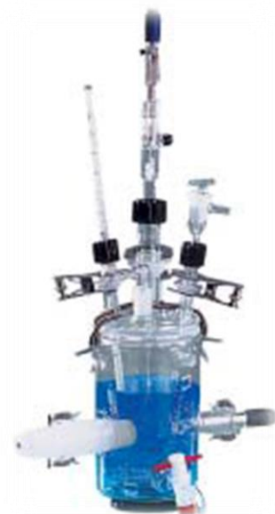
Fig.II.4 - Cellule électrochimique à trois électrodes
