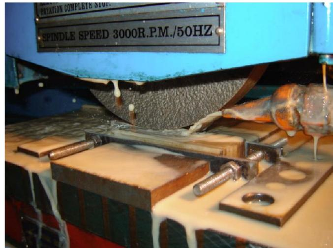
Fig. 2.3 : Rectification des éprouvettes
