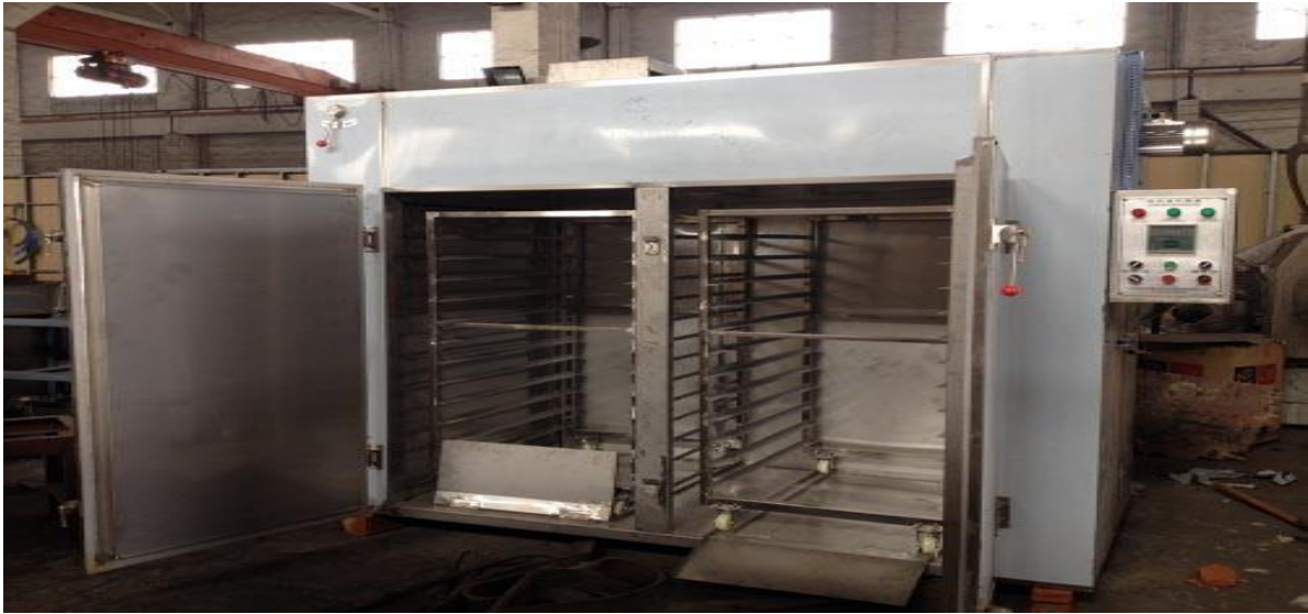
Figure n°13 : Séchoir à air chaud
