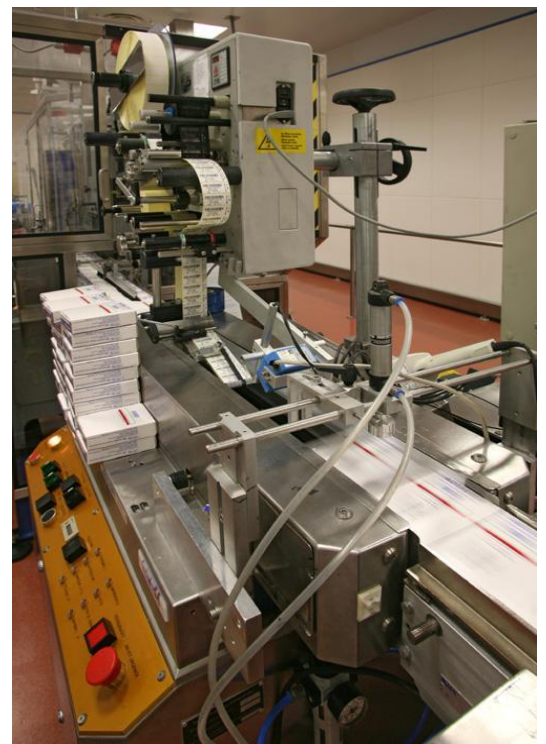
Figure n°17 : pilulier étiqueteur, emballeur automatique
