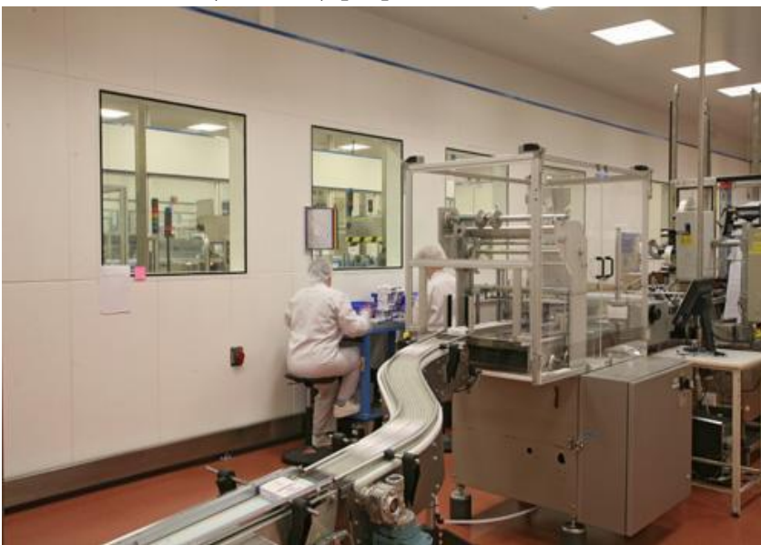
Figure n°17 : pilulier étiqueteur, emballeur automatique
