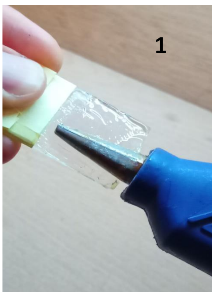
Pistolet thermique de P= 20\text{W} , T_{\text{max}} = 80\text{ }^\circ\text{C}
