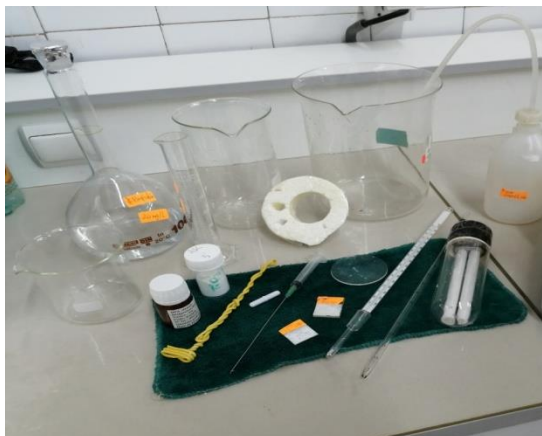
Figure A.5 : Produits utilisés ( \text{TiO}_2 , Ibuprofène), matériels et dispositif expérimental pour la dégradation de l'Ibuprofène par UV ;
