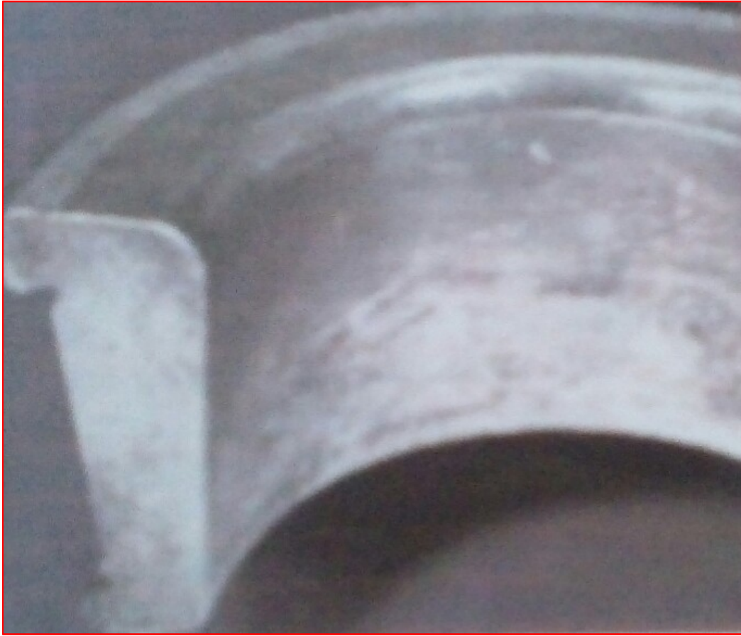
Fig. II.8. Corrosion de contact
