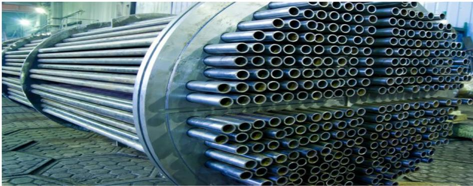
Figure I.8 : faisceau tubulaire
