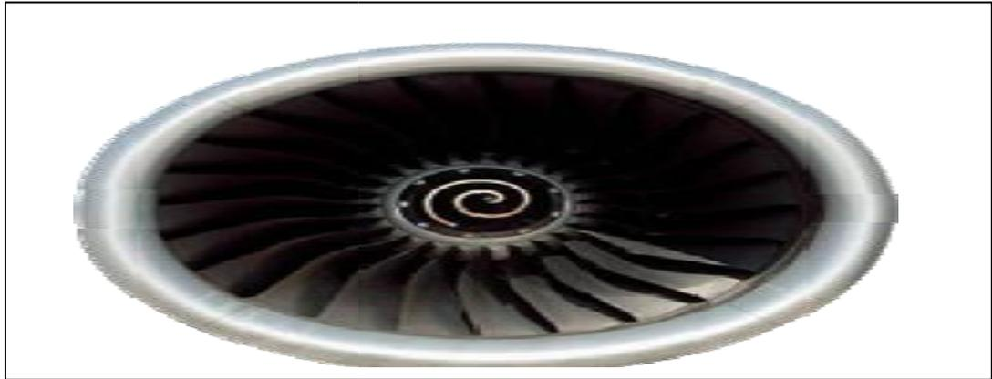
Figure II.4 : une entrée d'air (fan)
