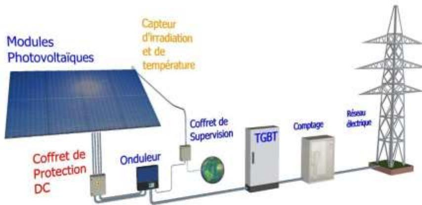
*Figure 2.19 : Le mode d'exploitation d'un système PV (connecté au réseau)*
