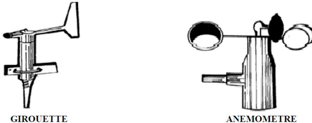
Figure II.5 Instrument de mesure de la direction et la vitesse du vent.
