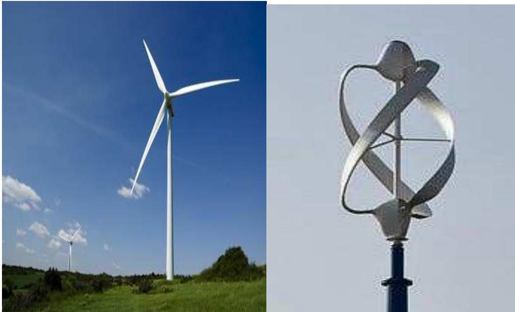
**Fig. I.5 : Eolienne à axe horizontal****Fig. I.6 : Eolienne à axe verticale**
