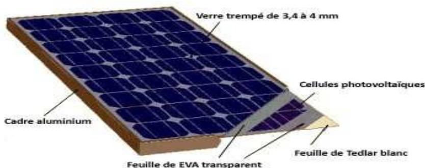
Fig. II.5 : Module photovoltaïque
