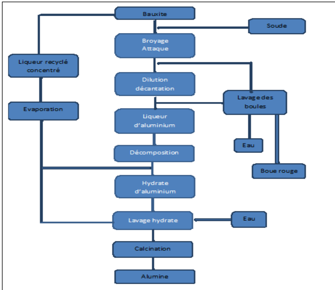
Figure .2. Production d'alumine à partir de bauxite : procédé bayer [46]
