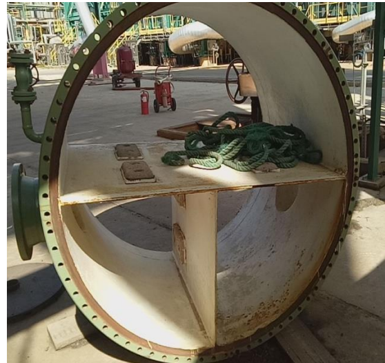
Figure 3-11 : l'autre emplacement des anodes sacrificiels[42]
