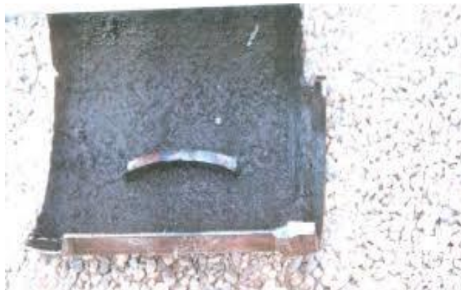
Figure 1-14 : corrosion d'un acier au carbone par le soufre. [37]
