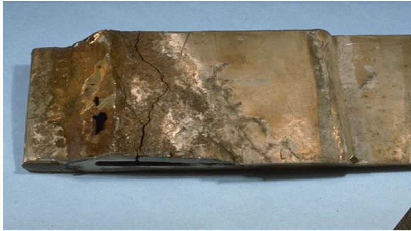
Figure 1-5 : corrosion sous contrainte d'une pièce. [33]
