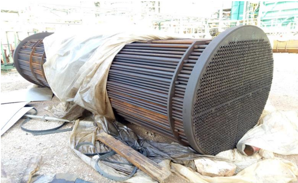
Figure 3-1 : échangeur 10-E-78A nouveau
