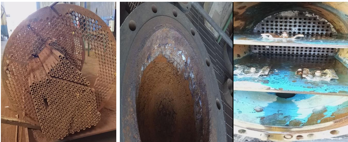
Figure 3-12: échangeur après l'utilisation (corrosion –érosion)
