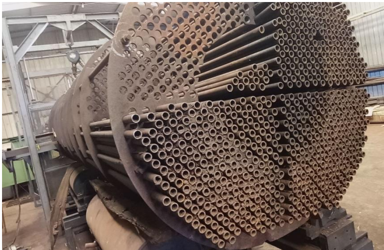
Figure 3-12: échangeur après l'utilisation (corrosion –érosion)
