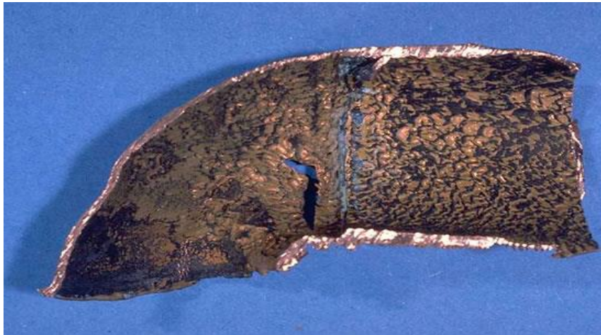
Figure 1-8 : corrosion érosion par effet de cavitation. [35]
