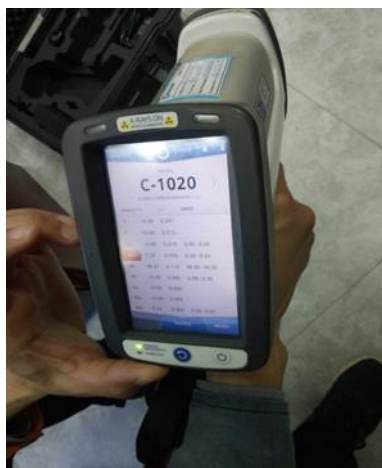
Figure 3-2 : Appreil(DRX) utilisé pour donner la composition chimique du metal.
