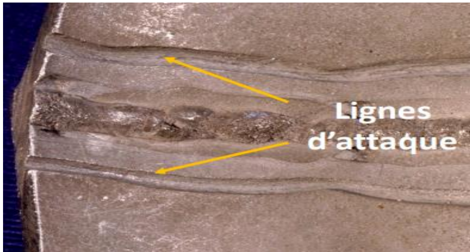
Figure 12 : Dégradation d'une soudure
