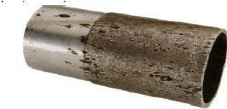
Figure III.24 : Corrosion par piqure.
