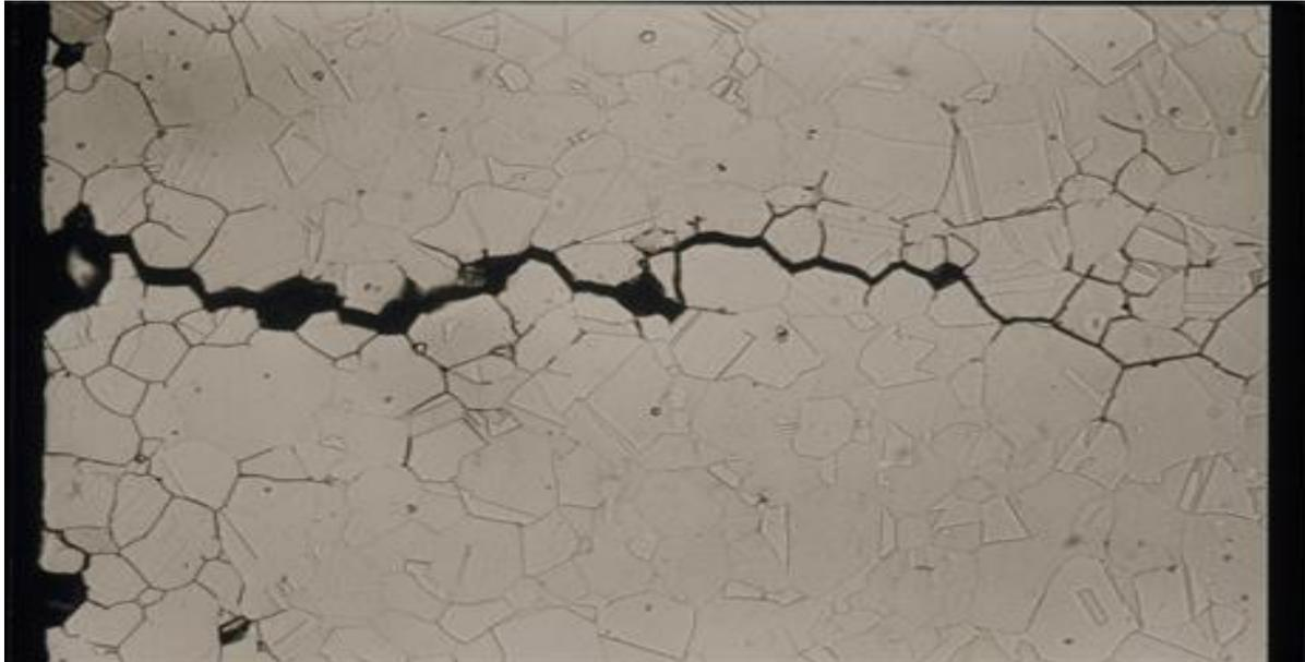
Figure III.27 : corrosion sous contrainte.
