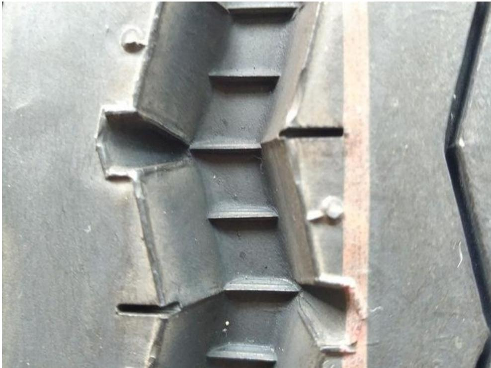
Figure : III.18 : L'usure par fatigue. [21]
