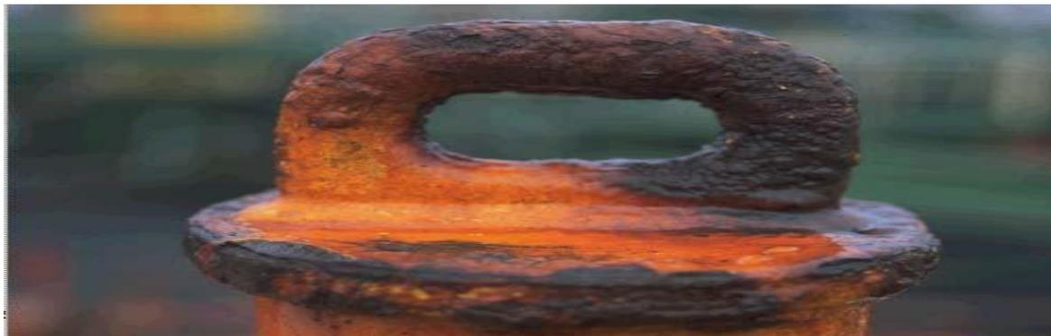
Figure III.21 : corrosion uniforme . [23]
