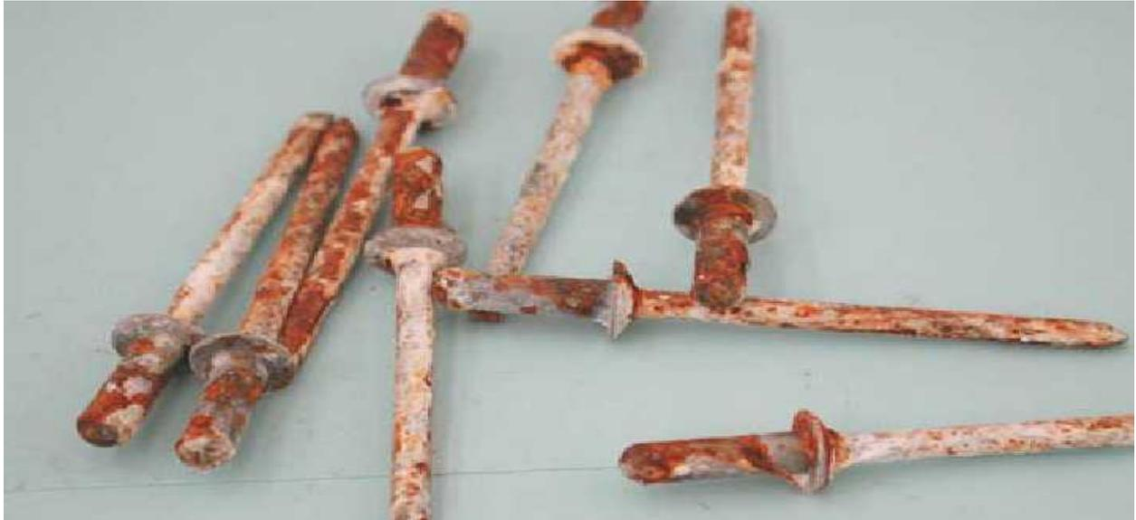
Figure : III.20 : corrosion chimique.
