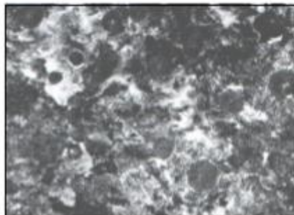
Figure II.7: FGS à matrice perlitique
