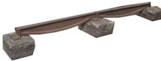
Figure II.7 : Rail en fonte posé sur des plots en pierre
