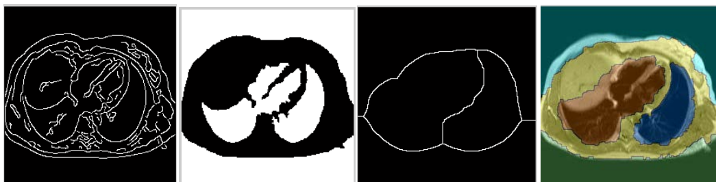
(b)-détection de contour(c)-les régions max(d)-ligne de séparation(LPE) (e)-image segmenté
