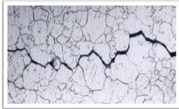
Figure – I.3 : Structure métallurgique touchée par la corrosion inter-granulaire
