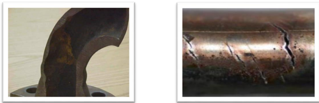
Figure – I.6 : Corrosion par érosion
