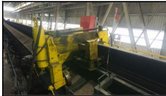
Figure III.21 : Déviateur des barres.
