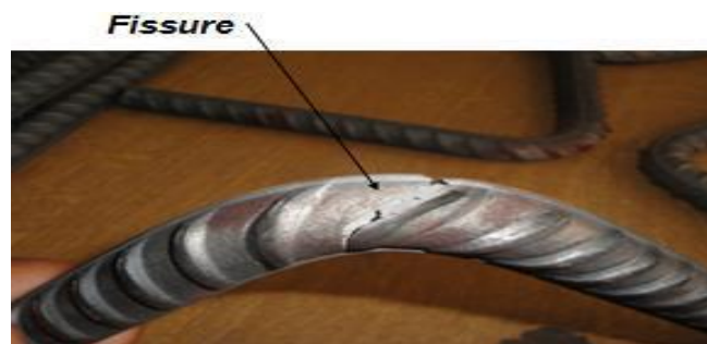
Figure IV.9 : Défaut de fissure.
