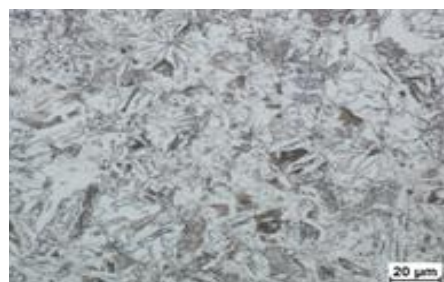
Centre de barre, Microstructure : ferritique – perlitique
