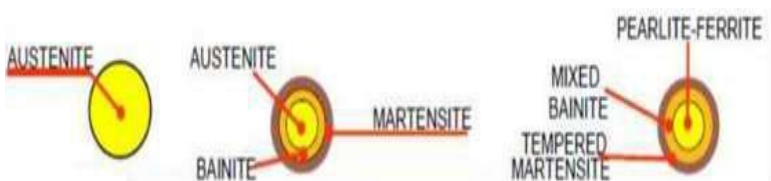
Figure III.18 : 03 phases finales de rond à béton TEMPCORE
