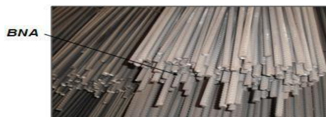
Figure IV.11 : Défaut de barre non alignée.
