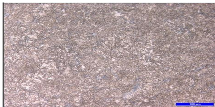
Figure II .19 : Micrographie optique de rond à béton de diamètre 25 mm, prise dans la 2ème zone d'extrémité de surface.
