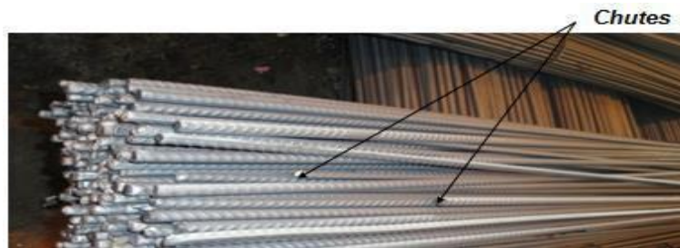
Figure IV.9 : Défaut de chutes.
