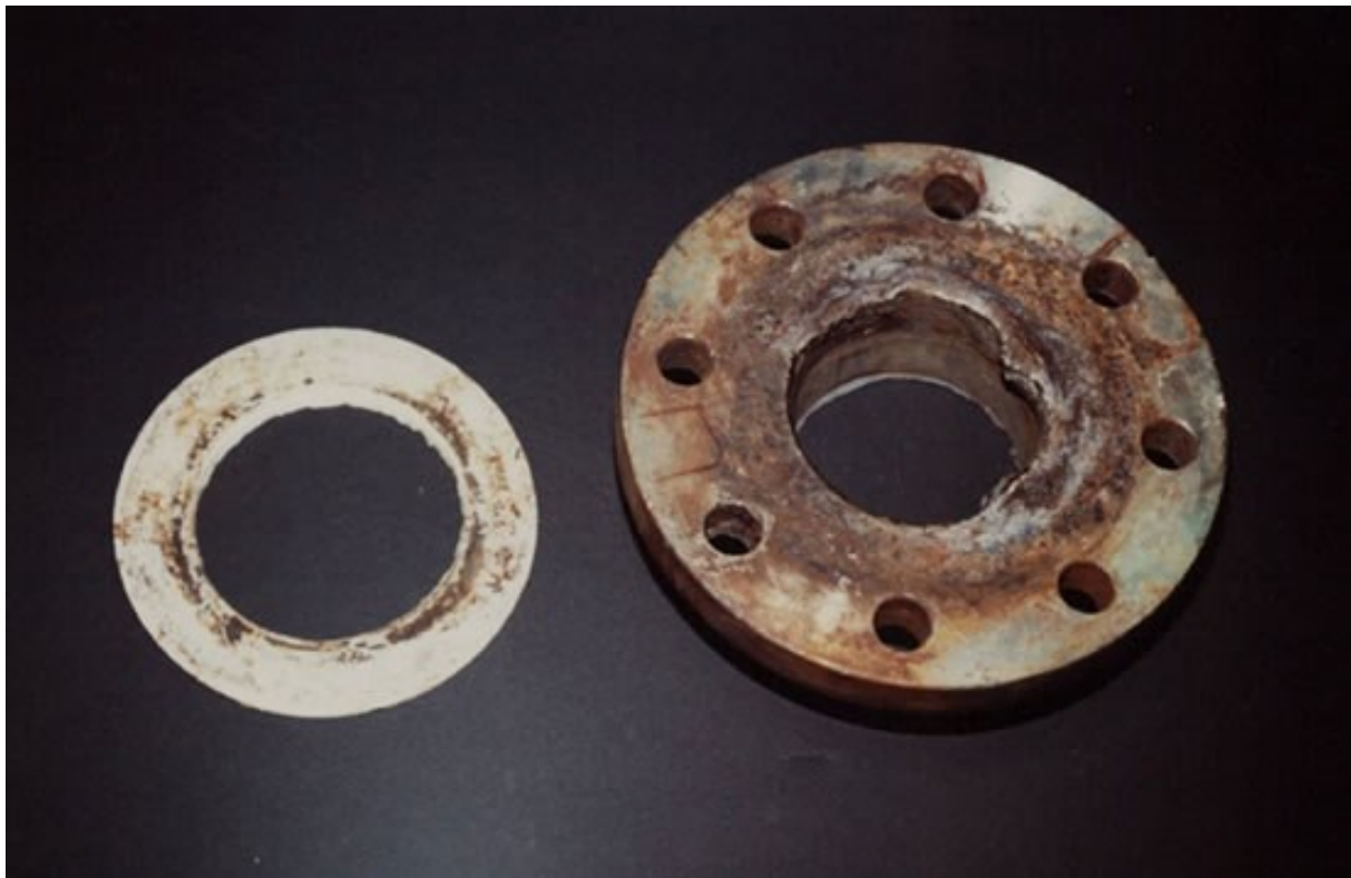
Figure 10 Corrosion caverneuse d'un acier allié sous un joint [3]
