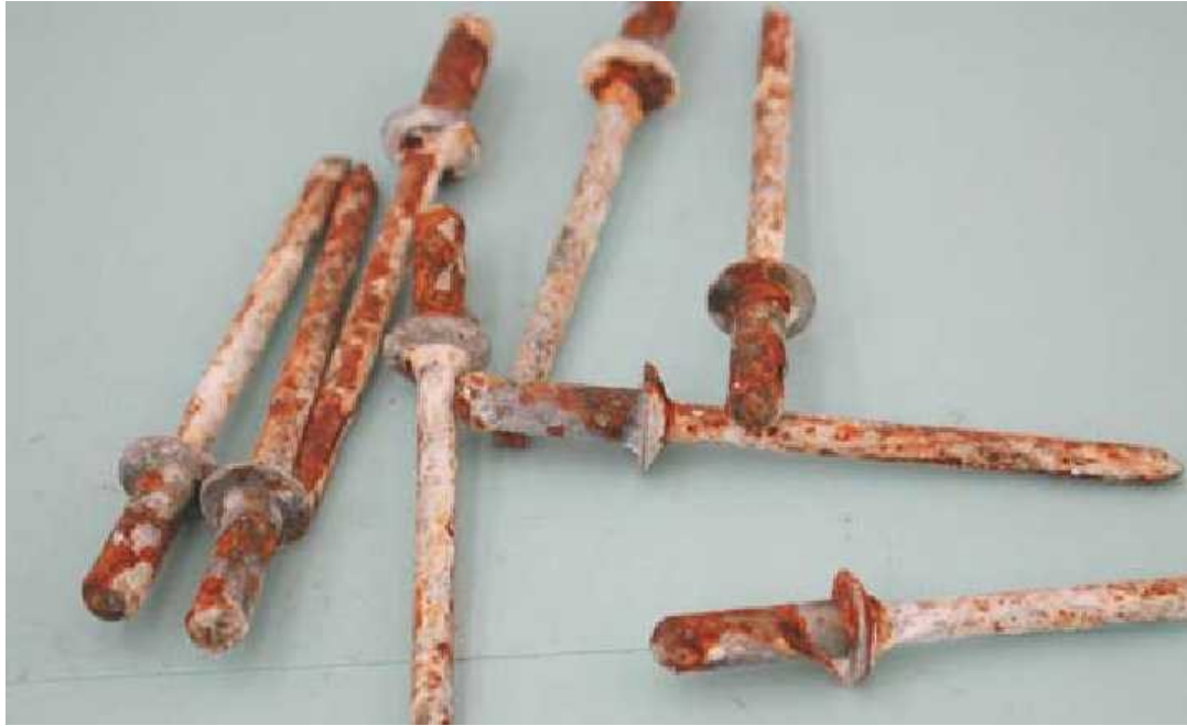
Figure 18 Corrosion chimique : effets sur les rivets et les inserts
