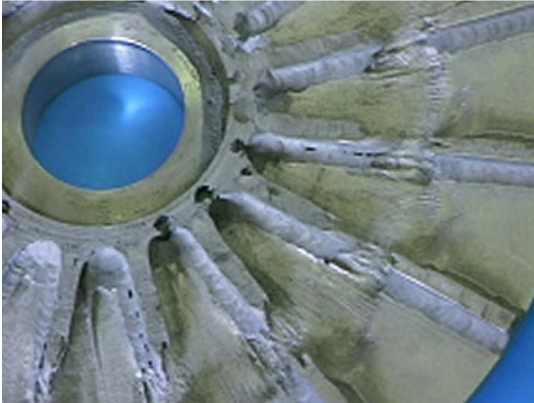
Figure 12 Corrosion cavitation d'une aube de pompe en alliage de nickel Hastelloy C276 en milieu acide chlorhydrique [3]
