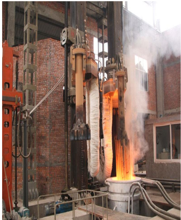
Figure 15: Four à refusion sous laitier électro conducteur [ 14 ]
