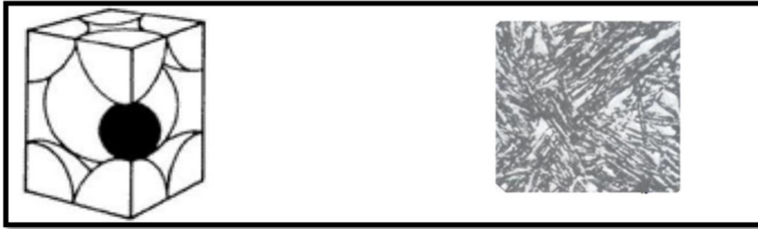
Figure 7: a) Le C dans la solution de martensite.
