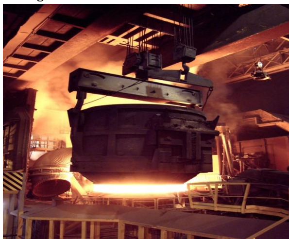
Figure 30: Panier de ferrailles pour le chargement du four à arc
