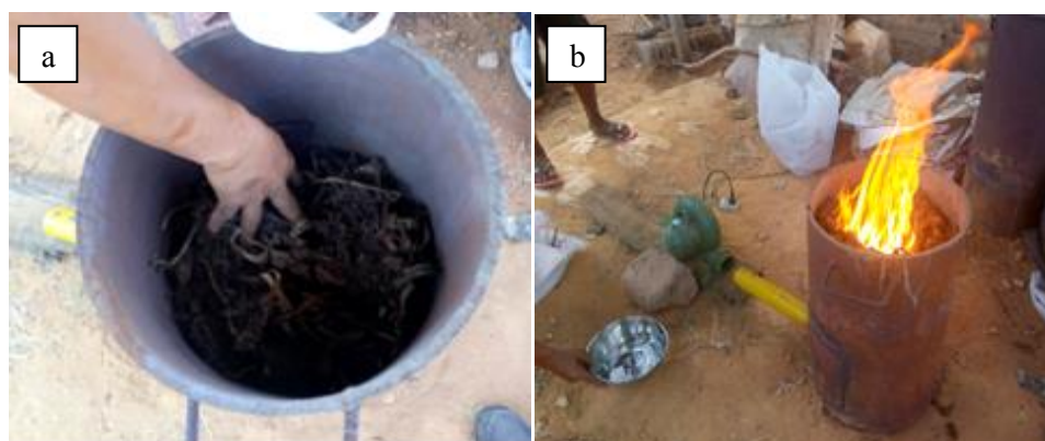
Figure.III.4. La biomasse séchée au soleil dans un fût en acier (a) et brûler la biomasse pour générer des cendres végétales (b).[97]
