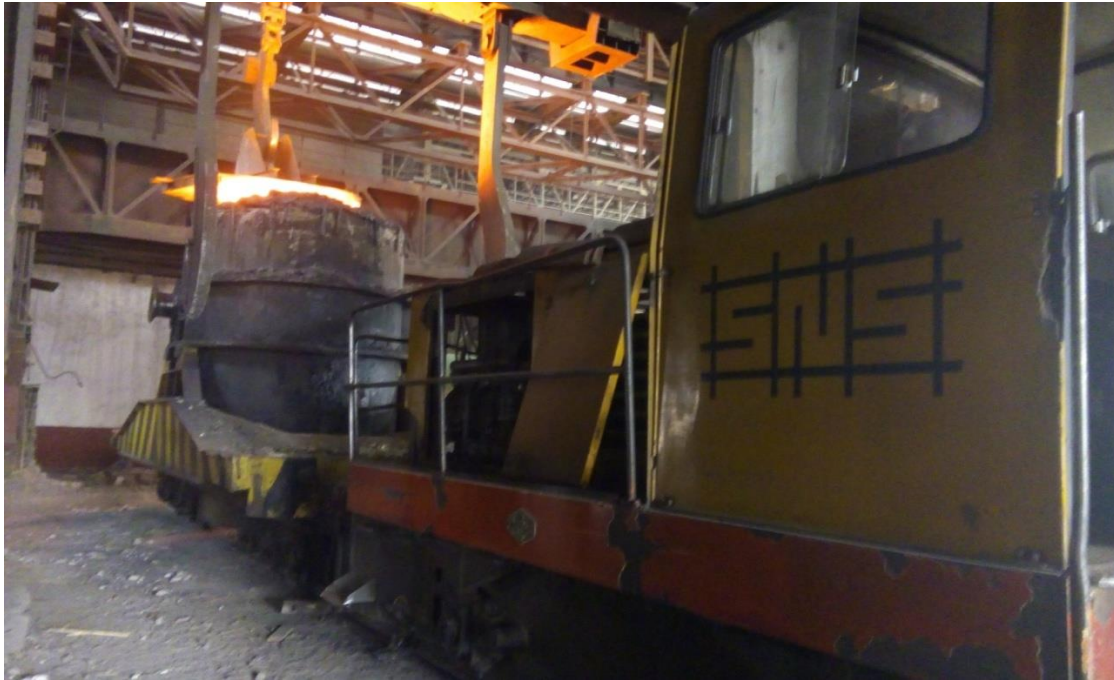
Figure 7 : Transport de la poche à acier
