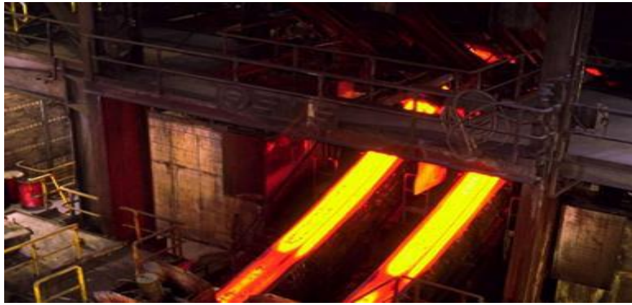
Figure 16 : Refroidissement secondaire simultané de deux billettes
