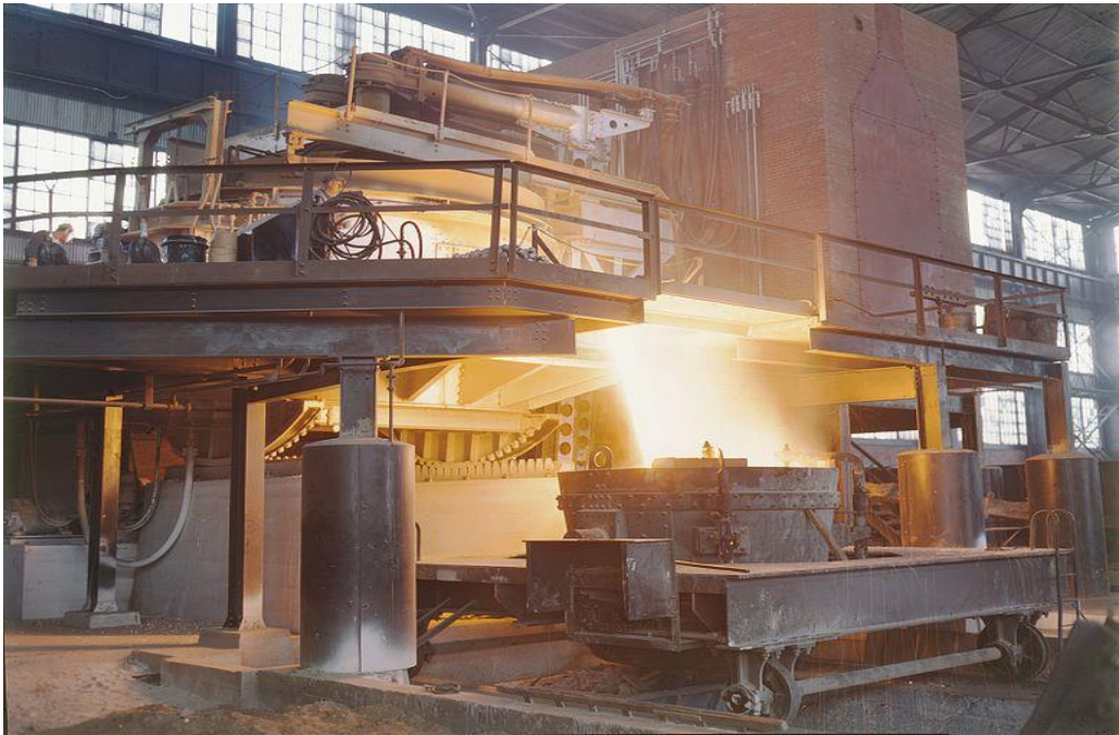
Figure 12 : Four électrique à arc
