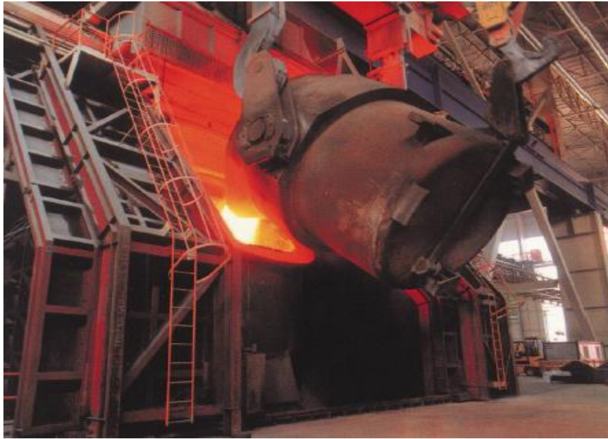
Figure 3 : Convertisseur à oxygène.
