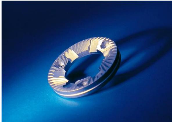
**Figure 1.7.** Industrie alimentaire : Disque de broyeur en acier de cémentation. Cémenté, boruré et trempé.
