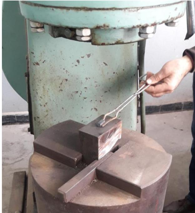
**Figure 3.4.** Déformation à froid des éprouvettes sur marteau pilon.
