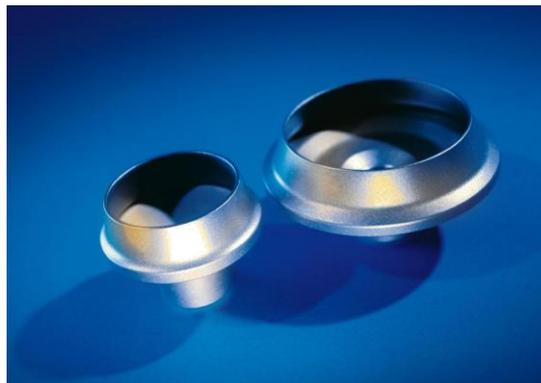
**Figure 1.8.** Industrie textile : tête de rotor pour production de fil. Acier boruré partiellement, trempe-revenu et revêtement.
