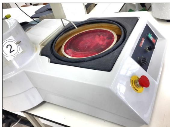
**Figure 3.13** Polisseuse de type Bitech Europe MP.
