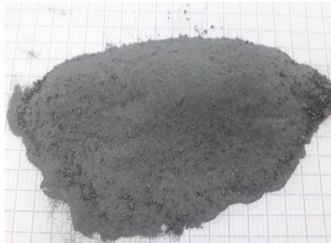
**Figure 3.10.** Mélange de poudres de boruration (5% B<sub>4</sub>C, 5% NaBF<sub>4</sub> 90% SiC).
