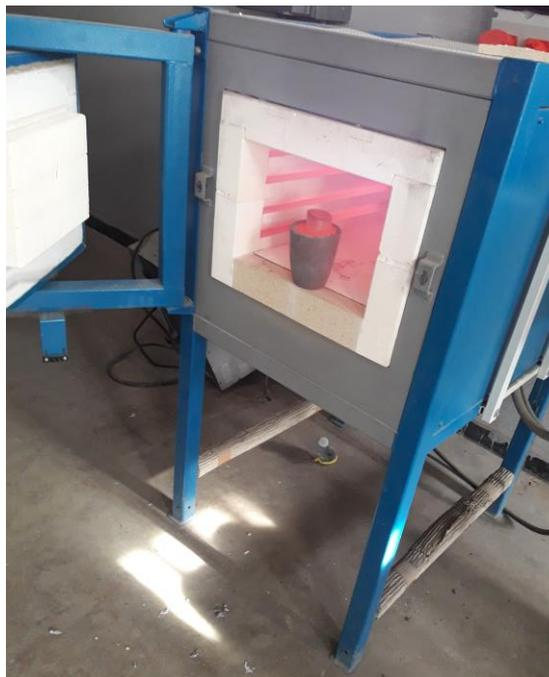
**Figure 3.7.** Four électrique de traitement thermique.
