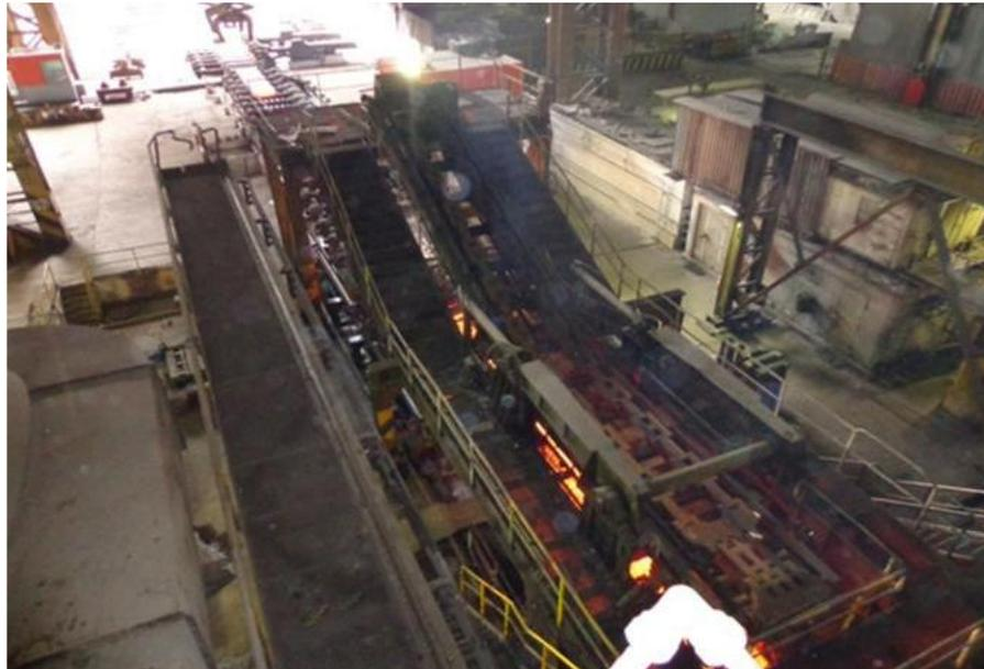
**Figure 18 : Le mannequin de la machine coulée continué**
