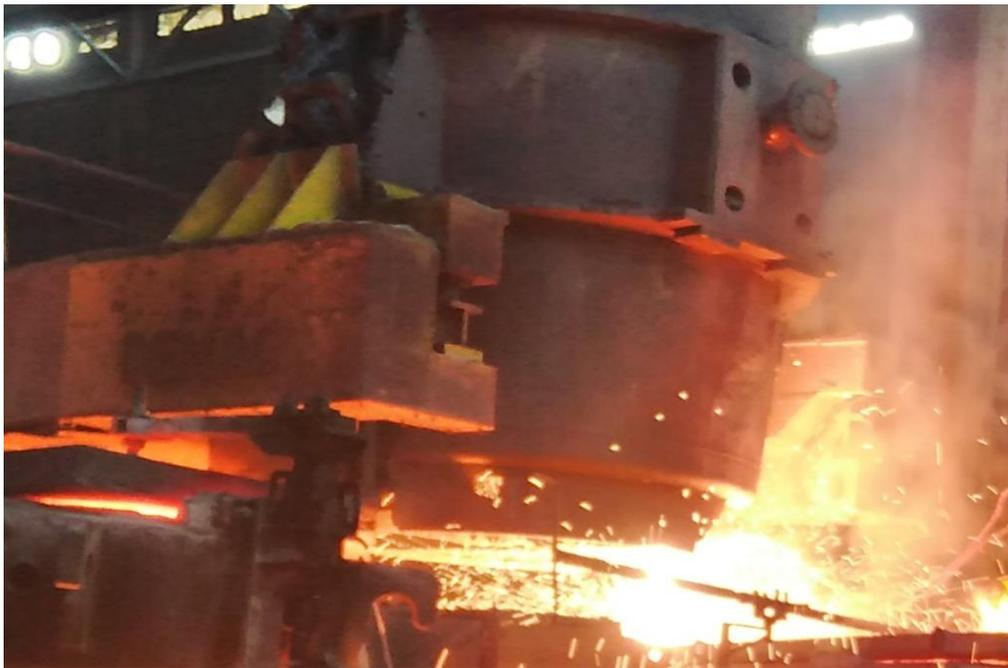
**Figure 15 : la poche à quenouille utilisée en SIDER**
