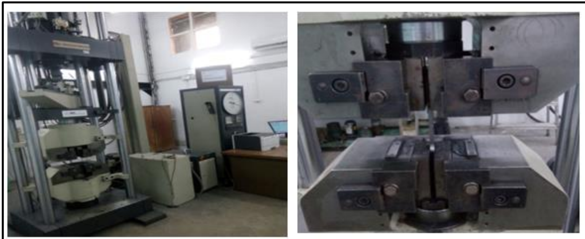
Figure II.5 : Dispositif expérimental pour les essais de traction sur machine « ZwickRoell ».
