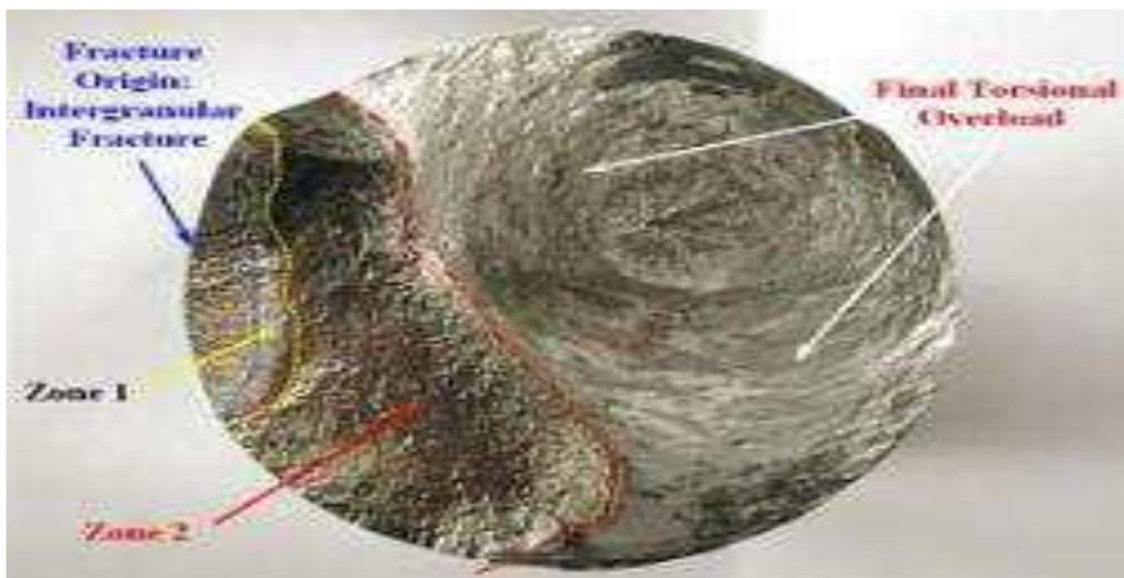
Figure I.12: Faciès de rupture d'un arbre de transmission de voiture de course.
