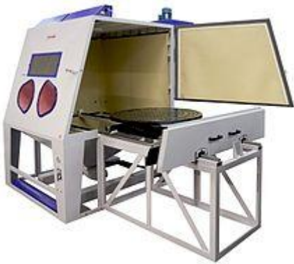
Figure. I.14 : Cabine de sablage pour pièces de grande dimension
