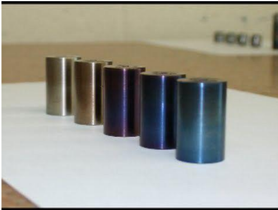
Figure. I.12 :Acier après un revenu de différents degrés (en fonction de la couleur)
