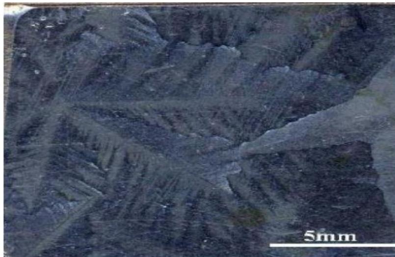
**Fig. (II.5)** Structure en fleur d'un revêtement galvanisé à chaud [2].
