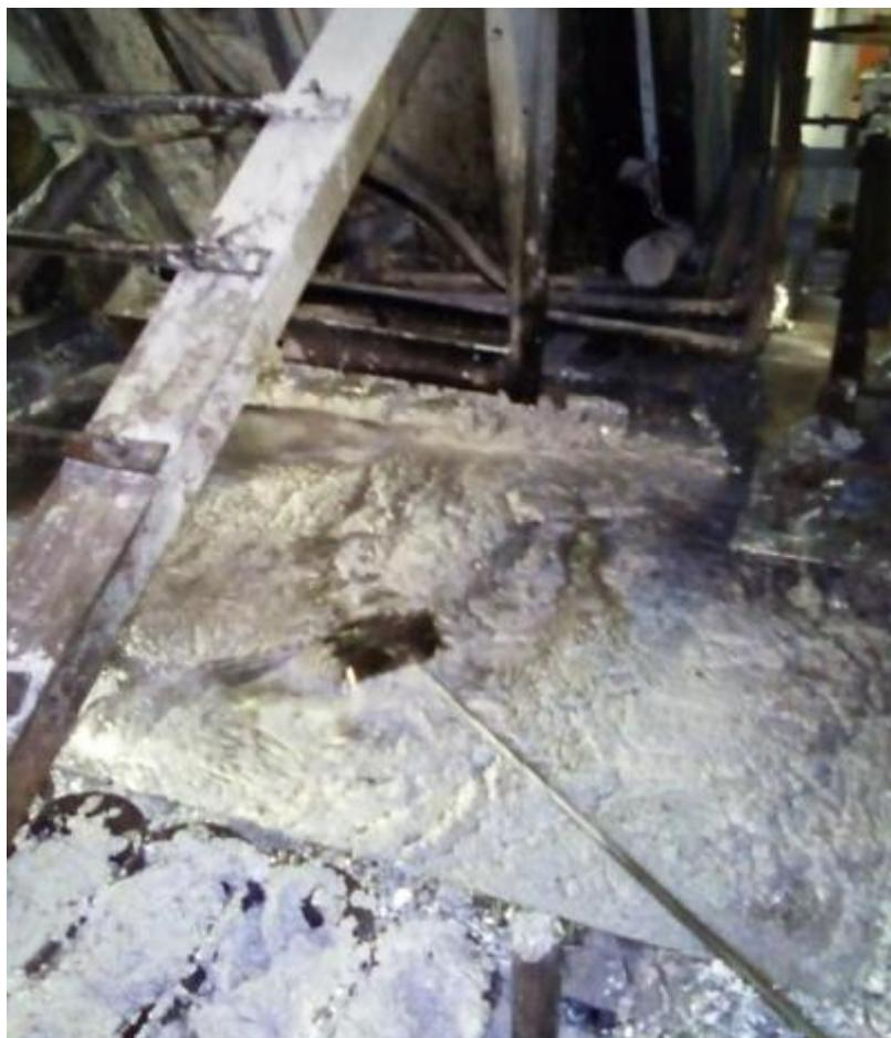
*Fig. III.10: Matte en surface dans le bain zinc.*
