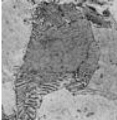
Figure II.10 : Début de la transformation perlitique d'un acier eutectoïde, la croissance lamellaire à partir des germes et la formation simultanée de ferrite et de carbure [44].
