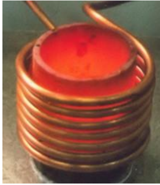
Figure II.4 : Chauffage d'un métal par induction [9]
