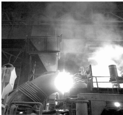
Figure II.22 : Parties refroidies du four à arc électrique. a) Panneaux faisant la partie supérieure de la coquille, b) toiture et c) conduit de dégagement de gaz.
