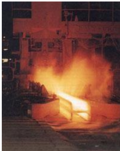
Figure I.5 : Laminage à chaud d'un profilé en I, Source : ARBED, Luxembourg . [25]
