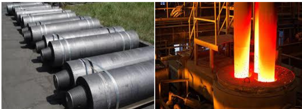
Figure II.48 : Les électrodes en graphite de four à arc électrique [19]
