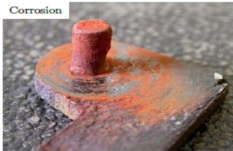
Figure III.5 : L'usure par réaction tribochimique
