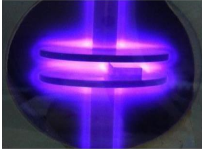
Figure V. 2 : Plasma formé dans la chambre de nitruration.
