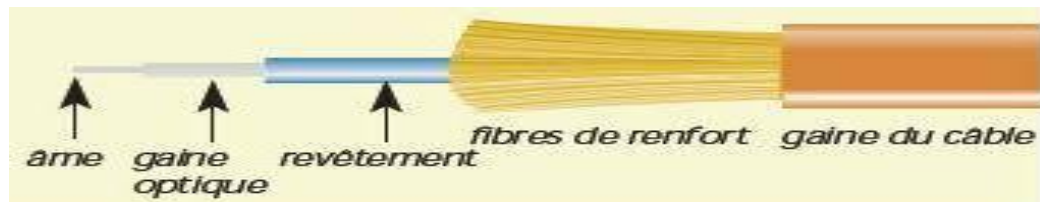
Figure I.2 : constitution d'un câble fibre optique
