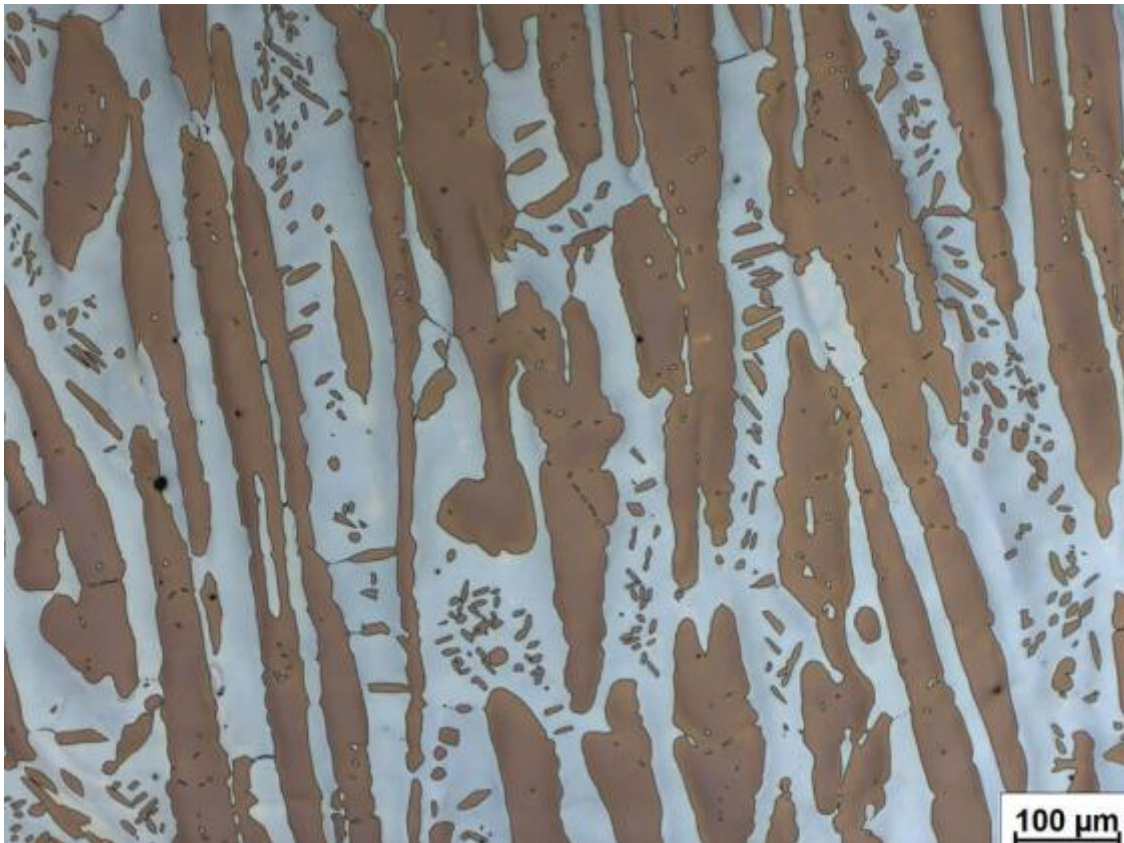
Figure 6: Acier duplex attaqué par électrolyse avec une solution aqueuse d'hydroxyde de sodium à 40 %, montrant de l'austénite marron et de la ferrite bleue. Fond clair.
