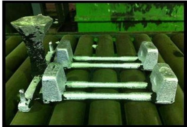
**Figure. IV.10 :** Éprouvette en coquille
