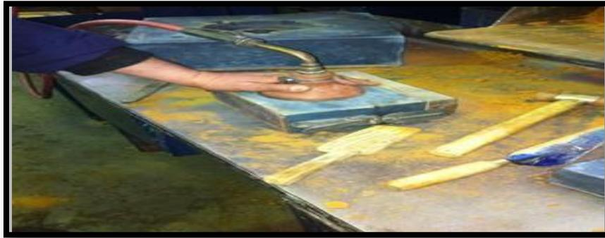
**Figure IV.6 :** Sable à prise chimique.
