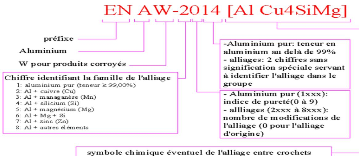
Figure III.1 : désignation des aluminiums et alliages – produits corroyés NF EN 573. [62]
