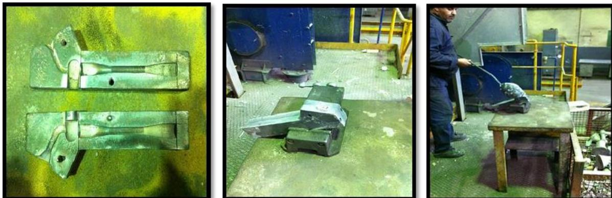
**Figure IV.9 :** moulage en coquille par gravité.
