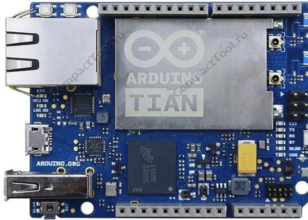
Figure 16 : Module Arduino Tian
