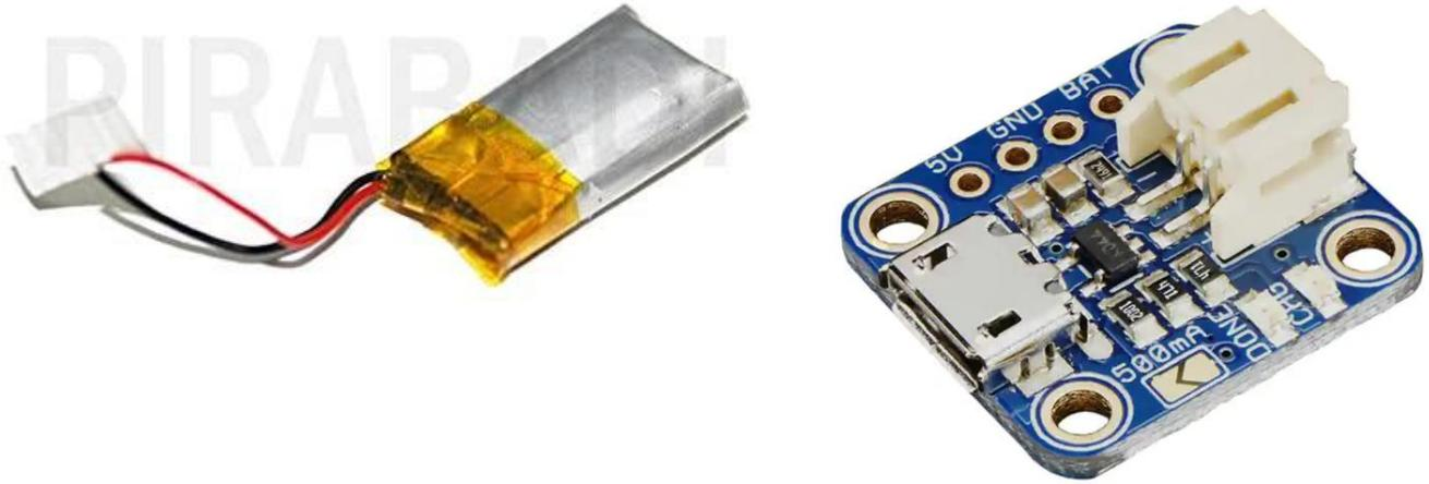
Figure 22 : Pile Li-po 3.7V 100mA et chargeur Li-po
