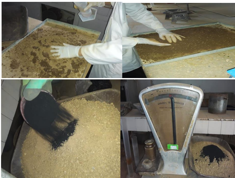
Figure III.3 Préparation du Mélange argile + déchet de pneu.
