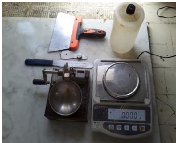
Figure II.6 Matériel utilisé dans l'essai de Limites d'Atterberg
