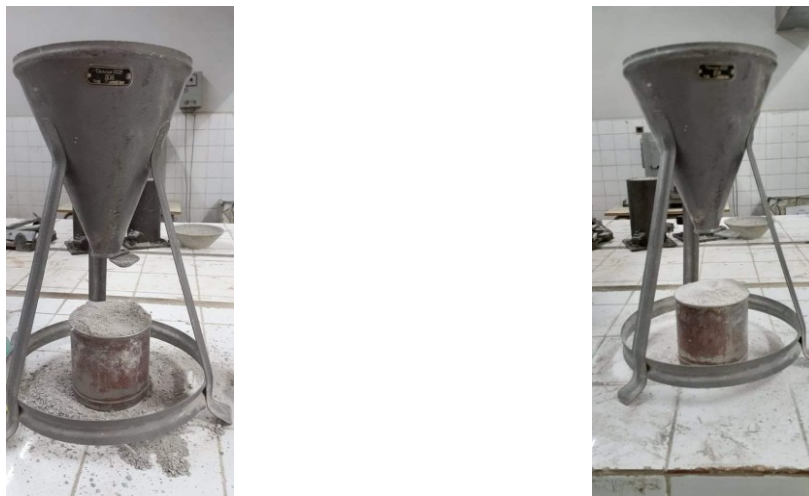
Figure III-7 Essai de mesure de la masse volumique apparente.
