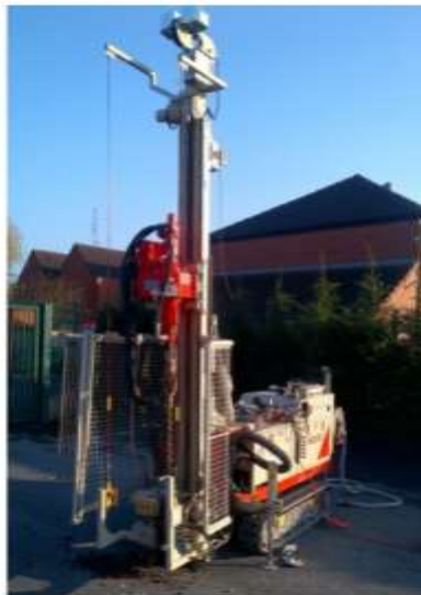
Foreuse GEO 205 Cornacchio
