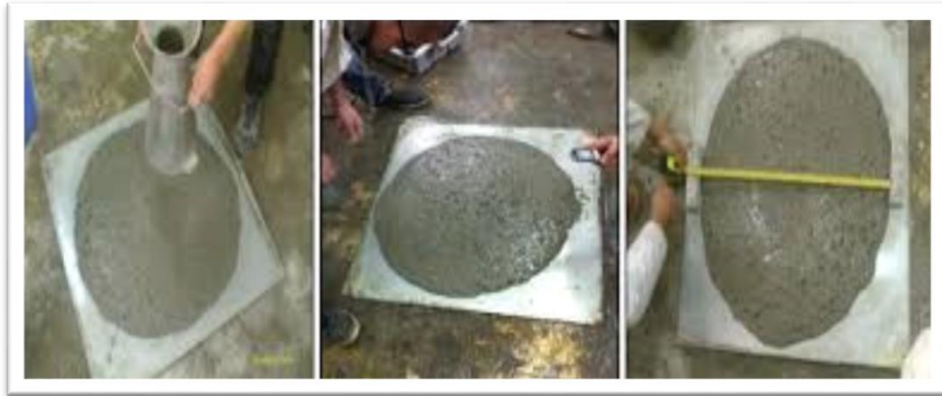
Figure I.8 : Essais d'optimisation des dosages en eau et en superplastifiant sur mortiers.
