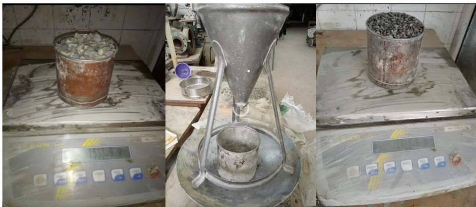
Figure II.3 : Procédé utilisé pour la mesure de la masse apparente du laitier cristallisé (3/8 et 5/16)
