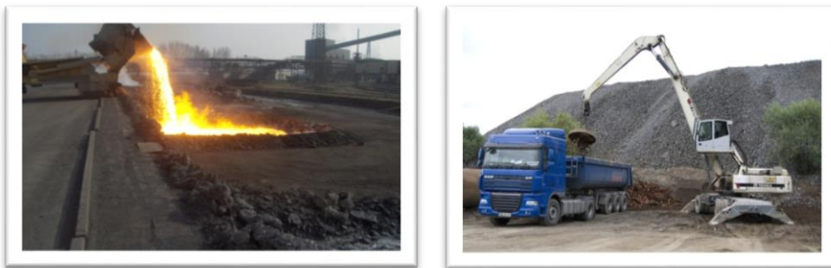
Figure I.3 : Refroidissement lent du laitier cristallisé.
