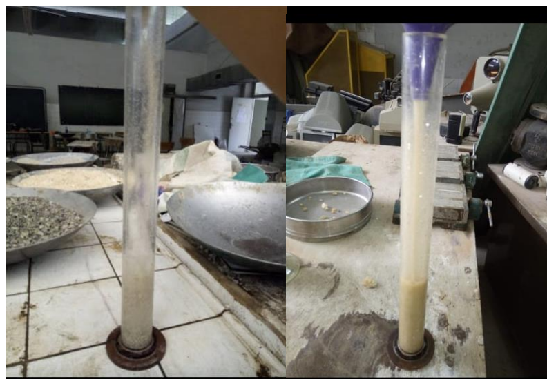
Figure II.4 : Mesure de la masse volumique absolue du laitier granulé et sable siliceux.
