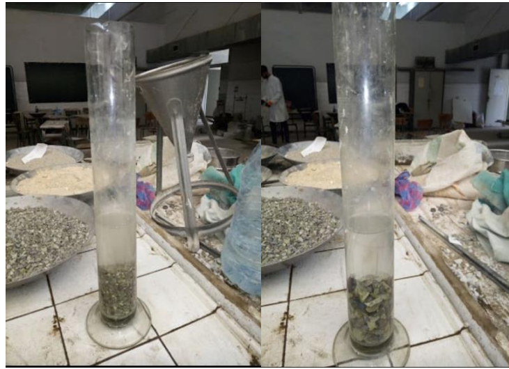
Figure II.5 : Mesure de la masse volumique absolue du laitier cristallisé 3/8 et 5/16.
