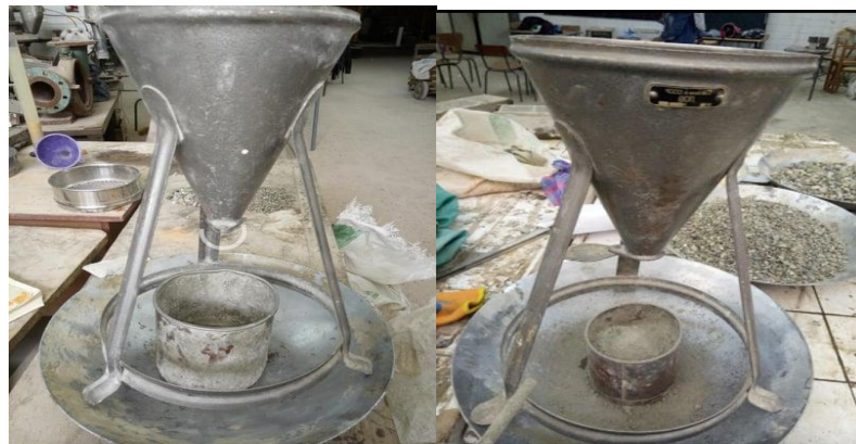
Figure II.2 : Mesure de la masse volumique apparente du laitier granulé.
