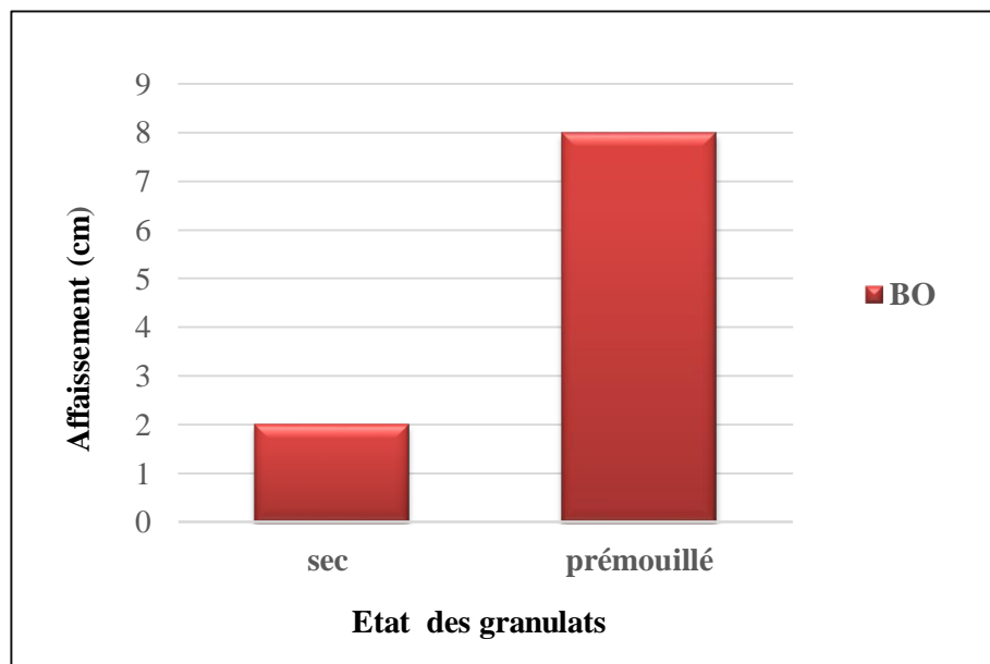
Figure IV.1 : Affaissement du BO avec granulats de LC à l'état sec ou prémouillé.[48]
