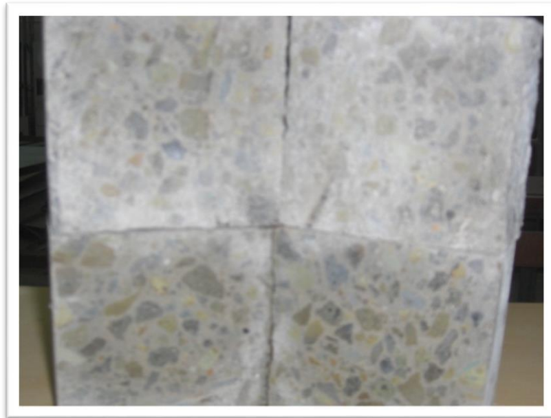
Figure IV.7 : Observation de la répartition des granulats du BO 0 %.[48]
