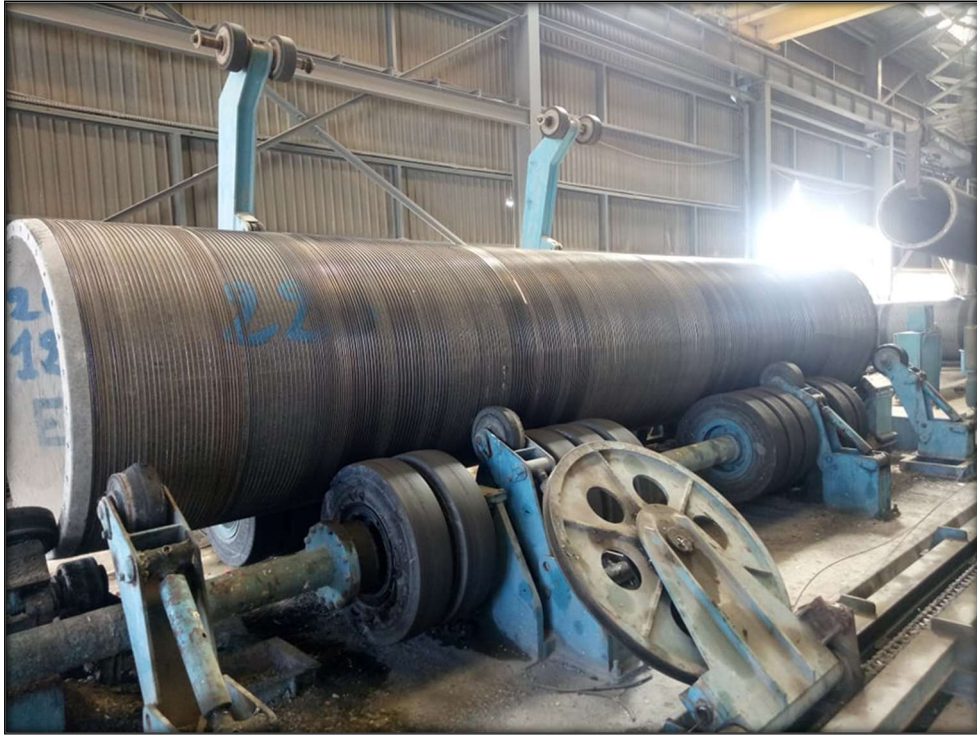
Figure 49-un tuyau EB/FB en fin de frettage
