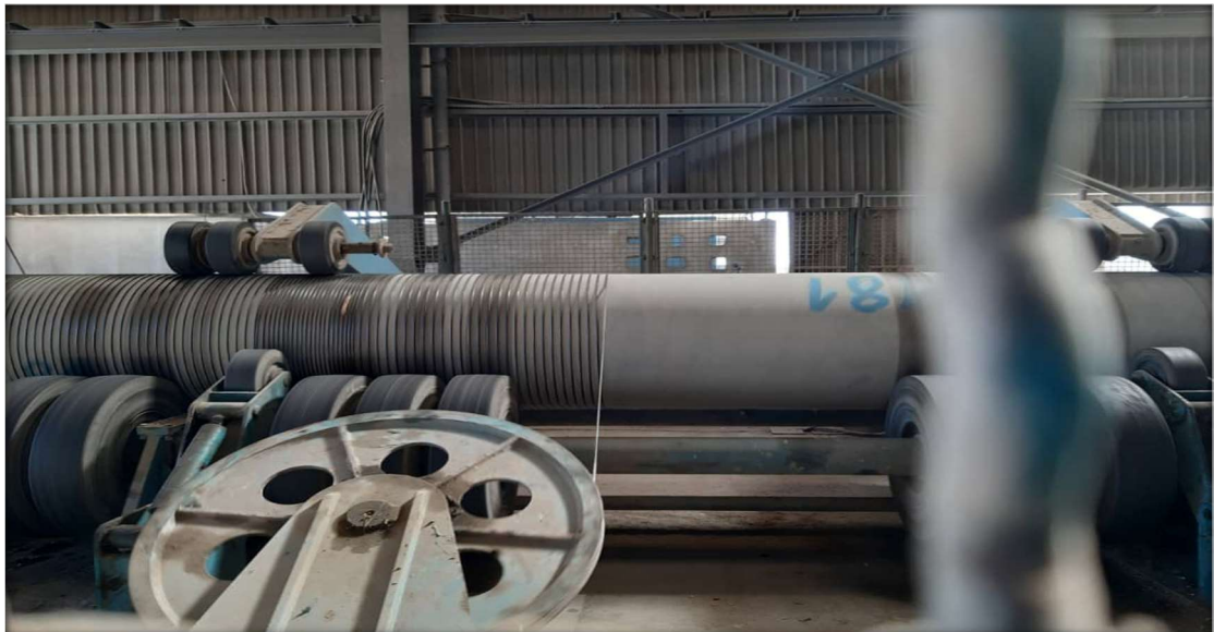
Figure 32-Application de la précontrainte radiale
