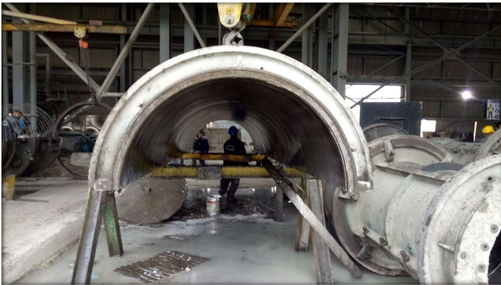
Figure 23-Coquille supérieure du moule
