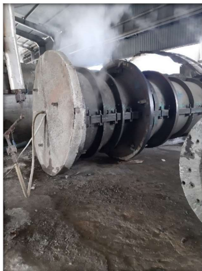
Figure 54-étuvage d'un tuyau
