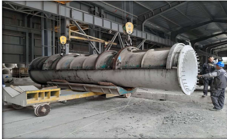
Figure 29-extraction du tuyau hors du moule
