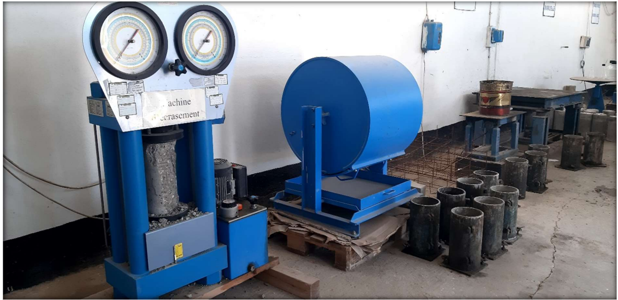
Figure 10- différente machine ( Machine d'écrasement - essai Los Angeles)
