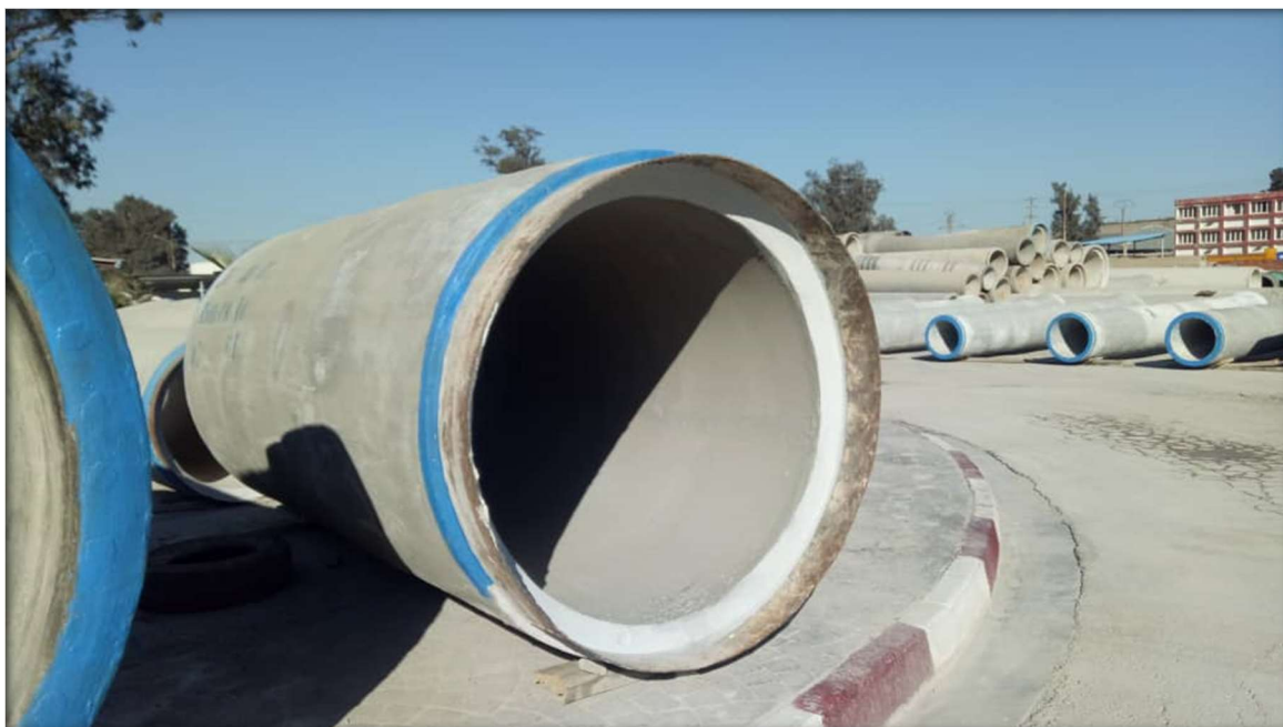
Figure 6-Tuyaux âme en tôle
